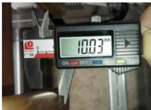
主开关进出线母排 厚度=10mm
