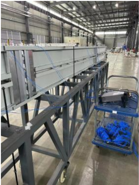
水平温升试验照片（不带分接单元）
